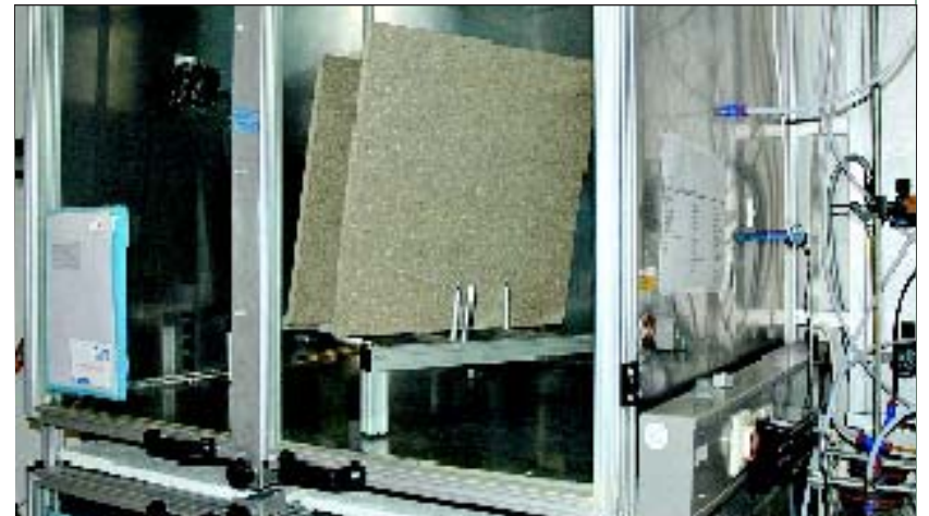
VOC-Prüfung wird in standardisierten Prüfkammern durchgeführt Foto: Müller
